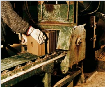
L'extrusion et la découpe en pains. Прессование и нарезка на части.
