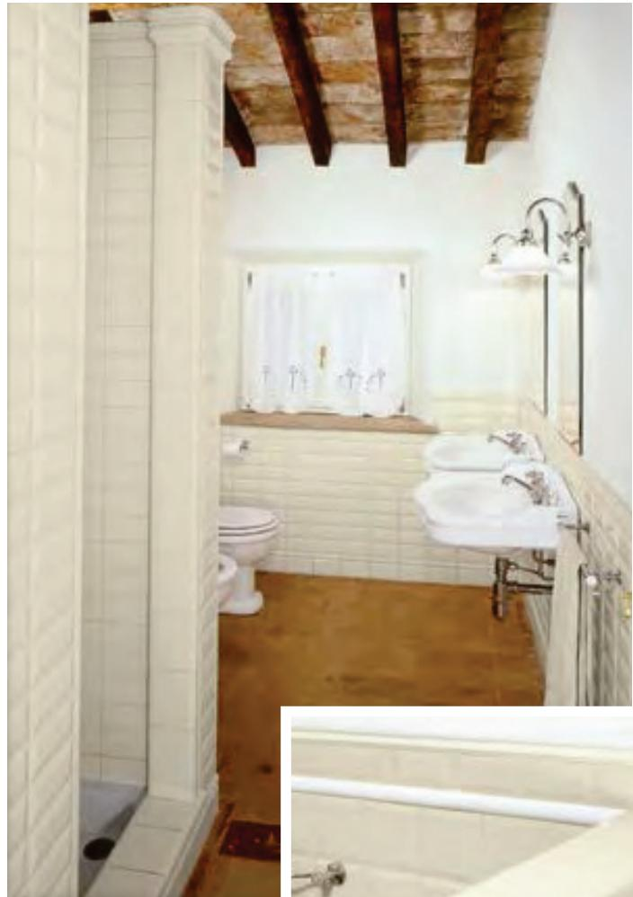
Per mantenere lo stesso livello orizzontale delle piastrelle, in prossimità del coprimuro PL7/PL8 utilizzare la Cornice Guimard quale proseguimento degli stessi.
