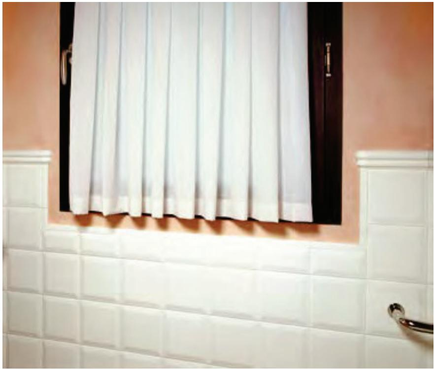
In prossimità di porta e finestra, fermarsi con la posa all'ultima piastrella intera, utilizzando il Bullnose per rifinire la costa non smaltata della piastrella stessa e il terminale dx/sx per cornice e battiscopa.
