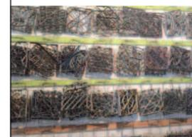
Dans un moule, on coule à l'aide d'un entonnoir un mortier liquide composé de pigments, de poudre de marbre et de ciment gris ou blanc suivant la teinte voulue.
